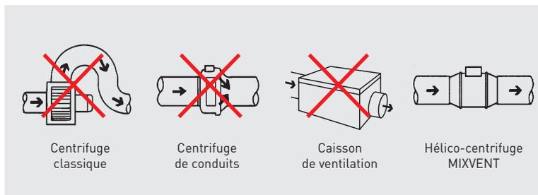
La hauteur réduite de la série TD-MIXVENT est la meilleure solution pour les installations où l'encombrement est limité comme dans les faux-plafonds.
